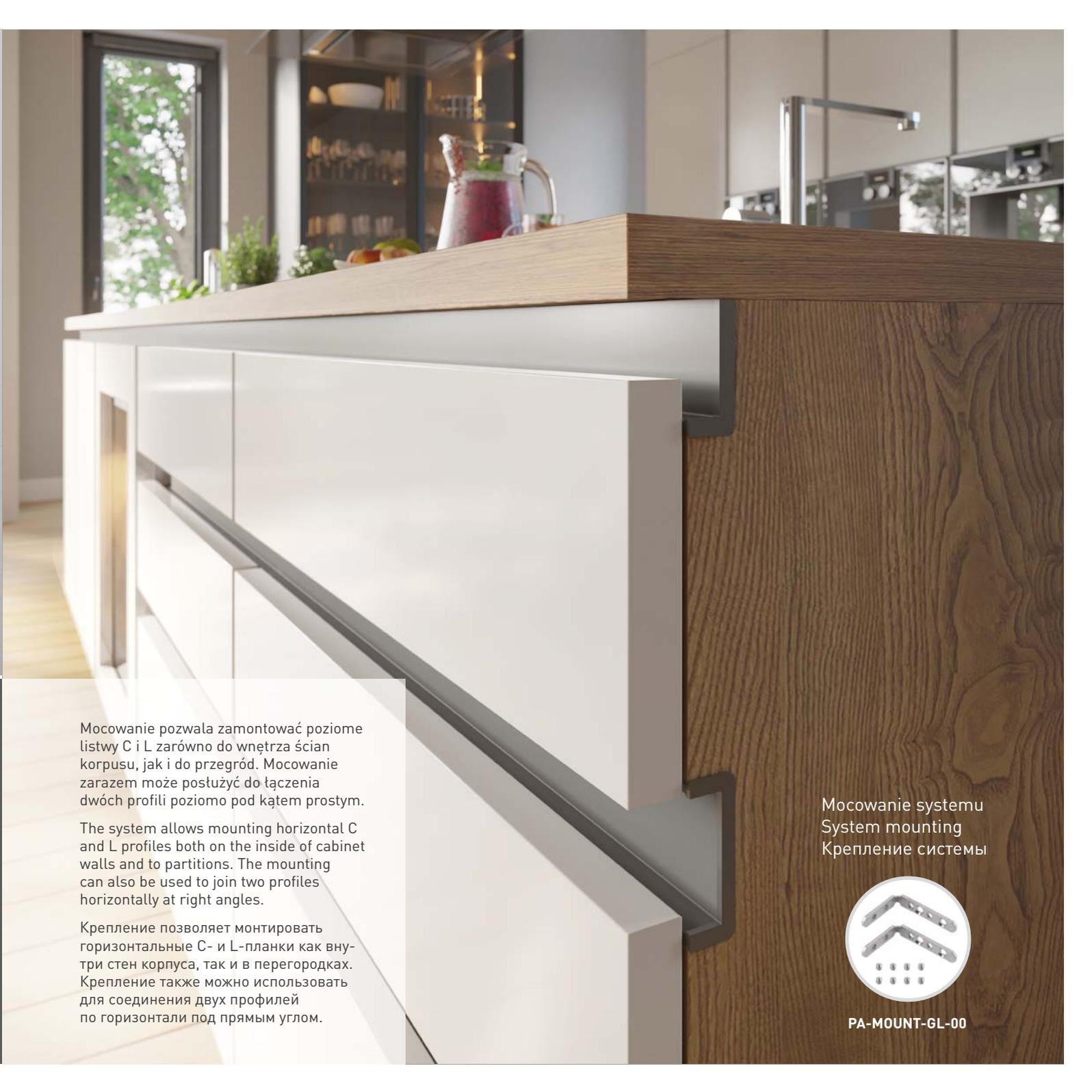
Mocowanie pozwala zamontować poziome listwy C i L zarówno do wnętrza ścian korpusu, jak i do przegród. Mocowanie zarazem może posłużyć do łączenia dwóch profili poziomo pod kątem prostym.
